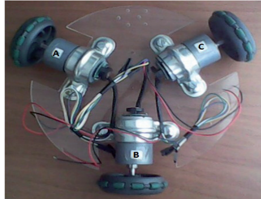
Fig. 2. Ruedas y motores sujetos a la base de acrílico
