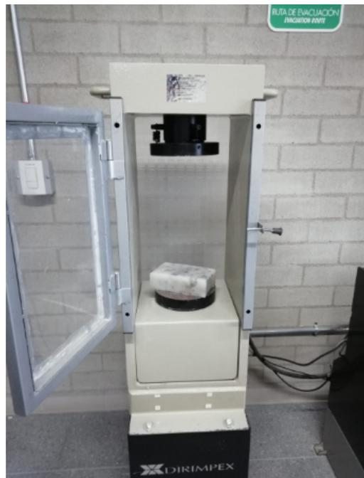
Figura 3. Pruebas de resistencia de los especímenes elaborados.
