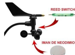
Fig. 1. Anemómetro y sus partes.
