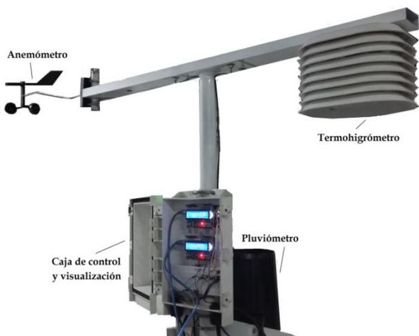
Fig. 15. Estación meteorológica.
