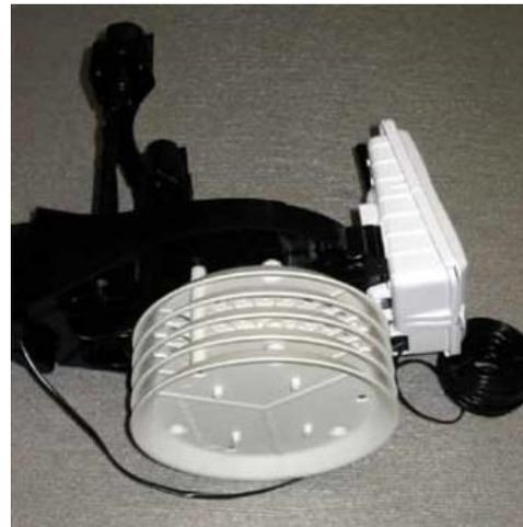
Fig. 7. Carcasa plástica del Termohigrómetro.
