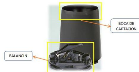
Fig. 2. Pluviómetro y sus partes.
