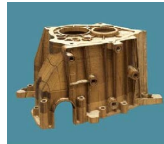
Fig. 5. Pieza fabricada mediante la técnica LOM
