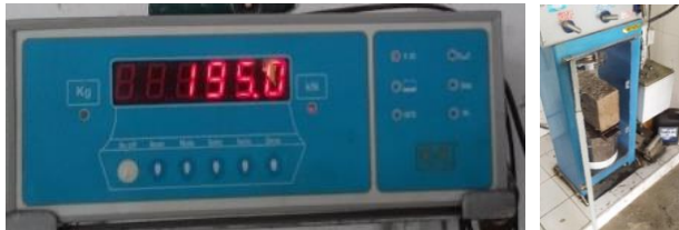
Fig. 13. Prueba de compresión a los 28 días. Resultados de la prueba. Archivo de los autores.
