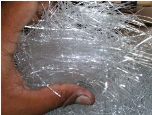
Fig. 2. Microfibra sintética estructural. Recuperado en: www.clasf.co.ve/q/macro-fibra-concreto/ [18]
