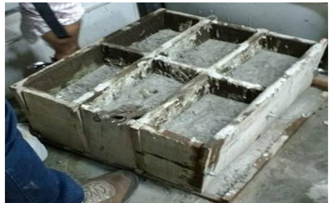
Fig. 6. Moldeado del ecobloque. Archivo de los autores.
