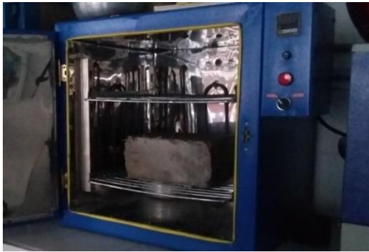
Fig. 8. Secado del ecobloque en el horno. Archivo de los autores.
