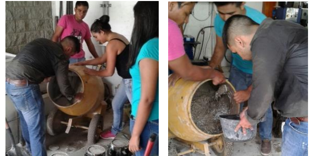
Fig. 5. Proceso de mezclado. Mezcla para fundir el ecobloque. Archivo de los autores.
