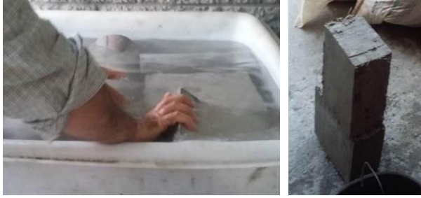
Fig. 7 Fundición y curado del ecobloque. Archivo de los autores.
