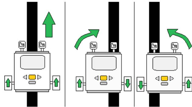
Fig. 4. Imagen del método seguidor de punto intermedio
