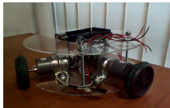
Fig. 3. Arduino Mega ADK sujeta a la segunda base
