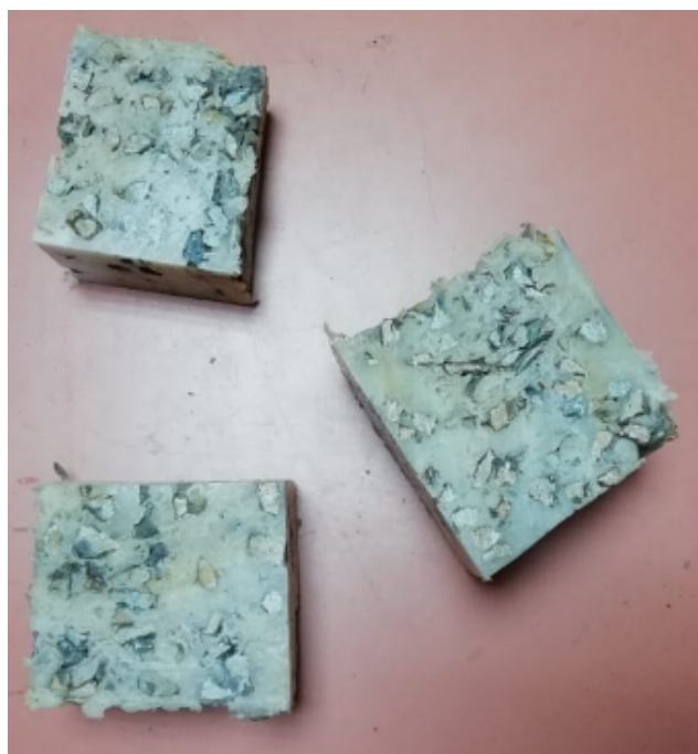
Figura 6. Estructura macroscópica de un corte al espécimen M6.
