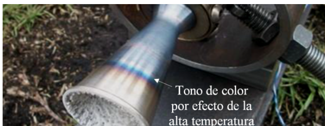
Fig. 1. Tobera cónica sometida a ensayo experimental en estática [8]. El tono de color más intenso indica que en esa región se presentó la onda de choque.
