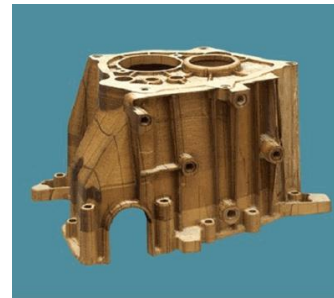
Fig. 5. Pieza fabricada mediante la técnica LOM
