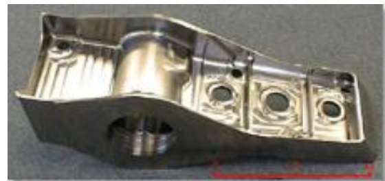
Fig. 6 Pieza fabricada con tecnología LAM
