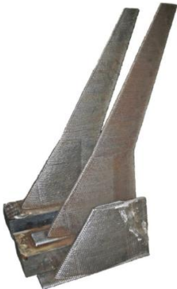
Fig. 3 Pieza de acero fabricada mediante tecnología WAAW
