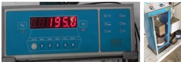
Fig. 13. Prueba de compresión a los 28 días. Resultados de la prueba. Archivo de los autores.
