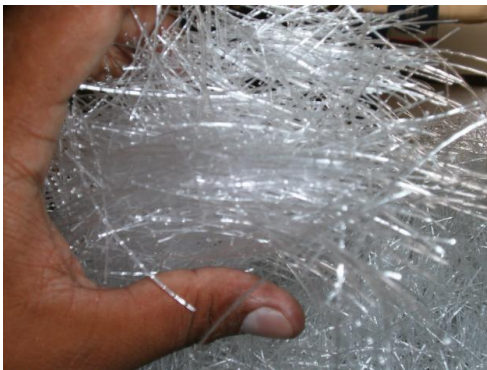
Fig. 2. Microfibra sintética estructural. Recuperado en: www.clasf.co.ve/q/macro-fibra-concreto/ [18]
